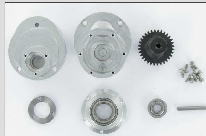
Einzelteile des Getriebegehäuses mit „Innenleben“ und Befestigung. Das Alu-Getriebegehäuse wird auch aus dem Vollklotz gefräst.
